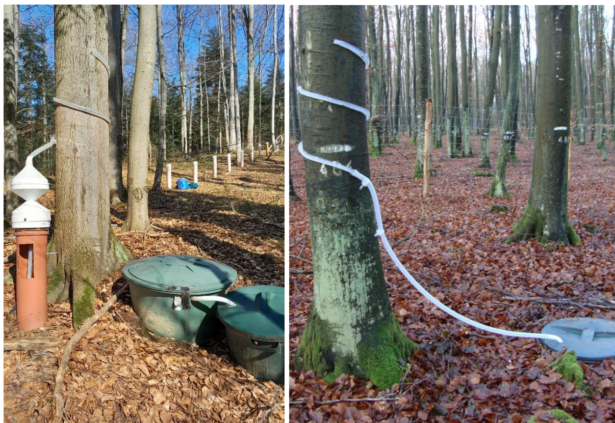
Fot. 2.4. Instalacje do pomiaru spływu po pniu na powierzchniach monitoringu intensywnego w Nadleśnictwach Bircza i Gdańsk (drzewostany bukowe)
