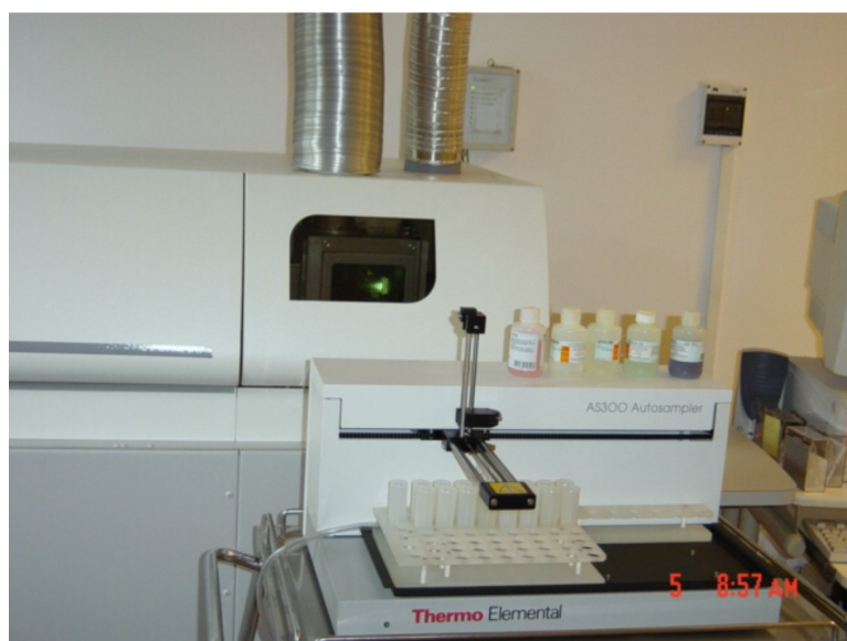
Fot. 10. Równoczesny spektrometr emisyjny ze źródłem ICP z plazmą poziomą - fot. Józef Wójcik
